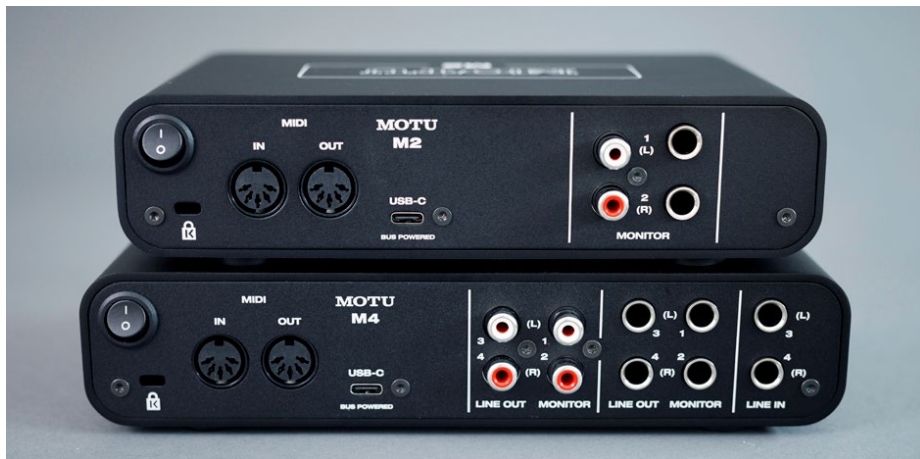
Einmal umdrehen bitte! Wem zwei Ein- und zwei Ausgänge nicht reichen, dem stehen mit dem größeren M4 (unten) zwei weitere (Line-)Eingänge auf der Rückseite zur Verfügung.
